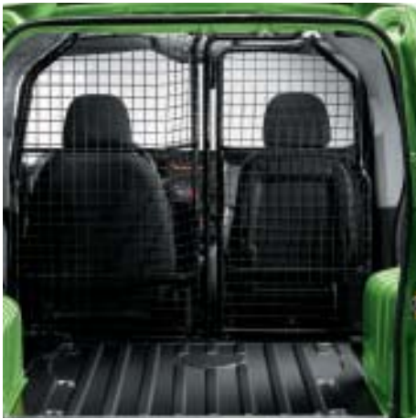
Paratia a griglia in due parti: fissa lato guidatore, girevole lato passeggero allineata al sedile ripiegabile a filo pavimento.
